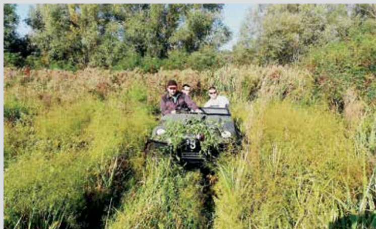
Ангажовање специјалне механизације - амфибија за приступ плавном терену - под трском и водом - ревизија 12 стубова ДВ 195/1 ТС НС 1- ТС Беочин, за напајање беочинске фабрике цемента.
