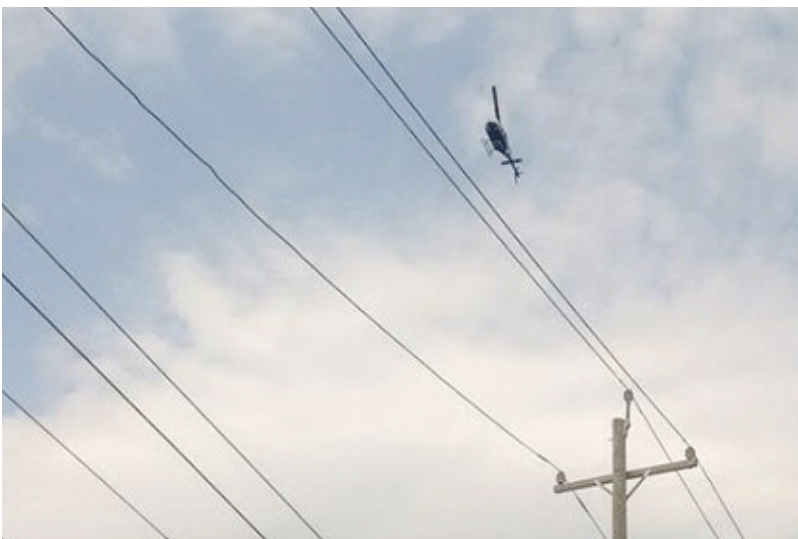
Хеликоптер за прикупљање података са LiDAR радаром лети изнад једног од симулираних сценарија оштећене мреже у центру за обуку предузећа NYSEG, при чему настаје тродимензионални приказ инфраструктуре који се аутоматски обрађује алгоритмима за аналитику података система ARIES како би се одредила процена штете.
