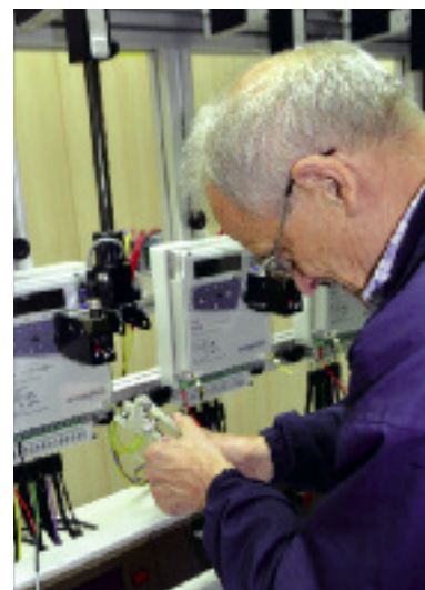
Водећи контролор Слободан Миленковић жигоше Трансформаторско бројило
