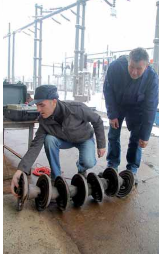
Замењене изолаторе у кругу Погона Ваљево испитивали су новопримљени приправник дипл. ел. Инж. Милан Филиповић и монтер Десимир Тришић
