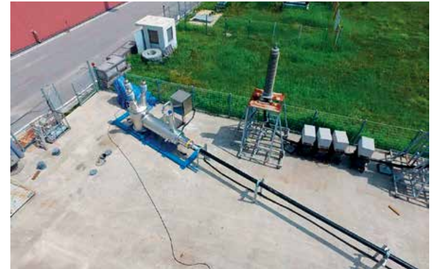
Типско испитивање 23 kV HTS кабл у КЕПЦО-овој испитној лабораторији Гошанг
